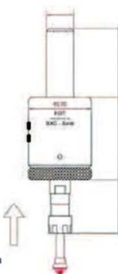
■ FDT Axial F für oben liegende Entgratanwendungen overhead deburring applications
